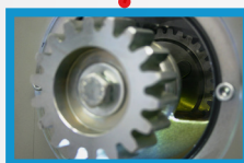
Przekładnia ze stali i brązu w kąpeli olejowej
