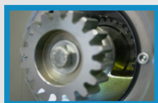
Przekładnia ze stali i brązu w kąpeli olejowej
